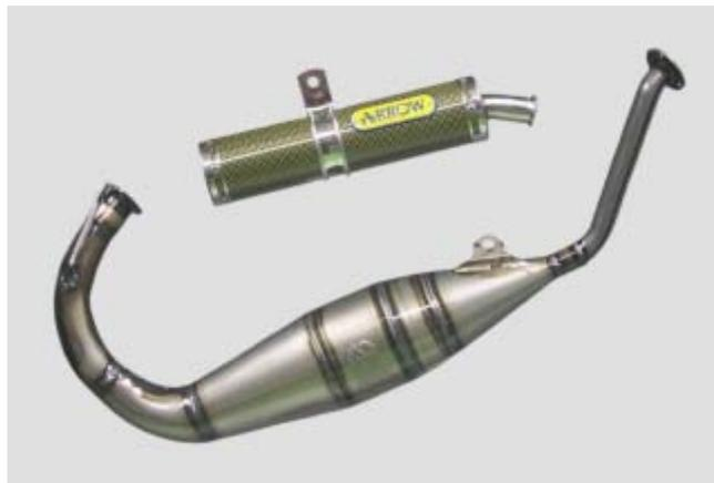
Es frecuente que la parte divergente, tenga un ángulo menor que la parte convergente. Ello es debido a que la primera onda se puede crear de una forma más progresiva ya que tiene más tiempo para actuar. En cambio, la onda de presión debe actuar muy enérgicamente en muy poco tiempo, justo el que va desde que el pistón cierra las lumbreras de transferencia, hasta que se cierre la lumbrera de escape, y quede la cámara de combustión sellada.
