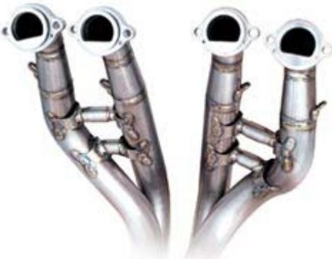
Se supone que si unimos los cilindros contiguos en el orden de explosión (1-4 , 2-3) nos beneficiaremos de mayor potencia en alta, que si unimos los cilindros contiguos físicamente (1-2 , 3-4). Sin embargo, la comunicación de varios colectores mediante el uso de **compensadores**, complican aún más la situación.
