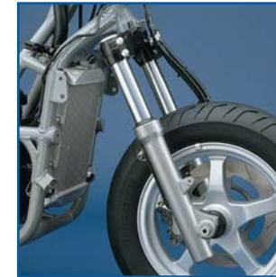
Horquilla delantera con barras de 41 mm de diámetro
